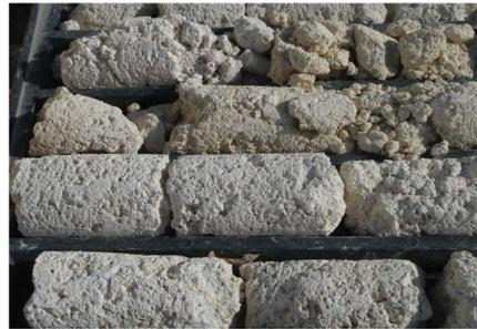
Figure 5. The calcarenite at the base of Conte di Troia.
