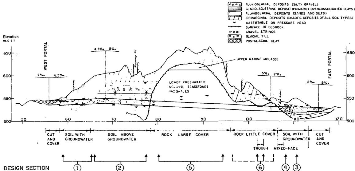
Fig. 2 Longitudinal geologic section
