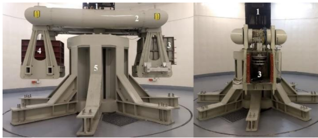
Figure 2. Universidad de los Andes geotechnical centrifuge
