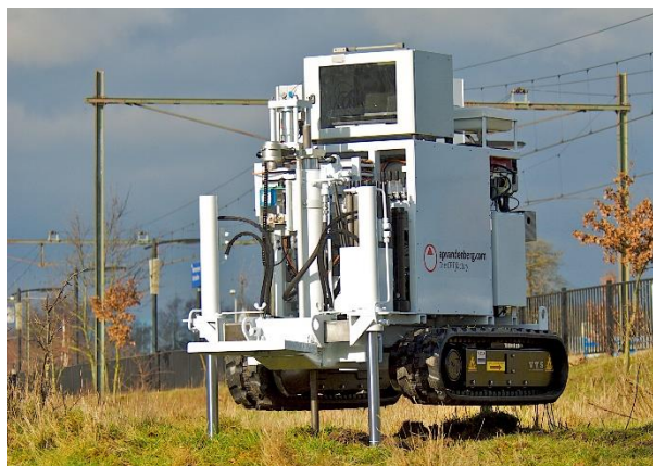
Figure 1. HYSON 100 kN in Mini CPT Crawler
