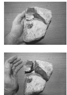
Figure 6. Gros granulats de STV récupérés après essai triaxial.
