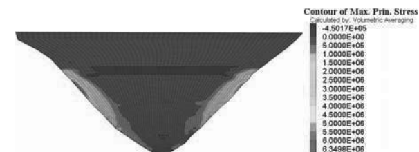
Figure 7. Traction (>0) aux bords du masque en fin de construction
