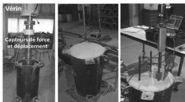
Figure 4. (a) essais de chargement œdométriques lors du compactage, (b) éprouvette compactée et (c) réalisation des essais Panda 3®.
