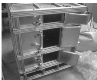
Figure 2. Cadres empilables composant le modèle réduit
