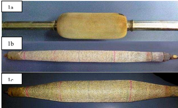
Figure 1. Vues de la membrane centrale gonflée à 1100 cm 3 (1a), de la gaine de contention non gonflée (1b) et gonflée à 1100 cm 3 (1c)
