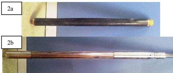
Figure 2. Sur-gaine (2a) et lamelles métalliques (2b) constituant la sonde FC.
