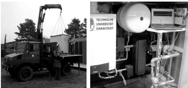
Figure 6. Mobile GRT equipment of Technische Universität Darmstadt.
