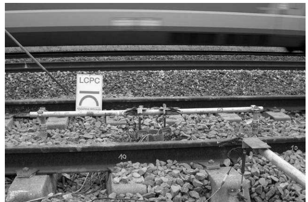
Figure 4. Vue de la colonne instrumentée avec les capteurs de déplacement
