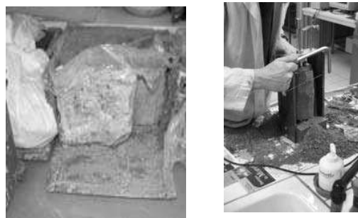
Figure 3 Découpe des éprouvettes de loess
