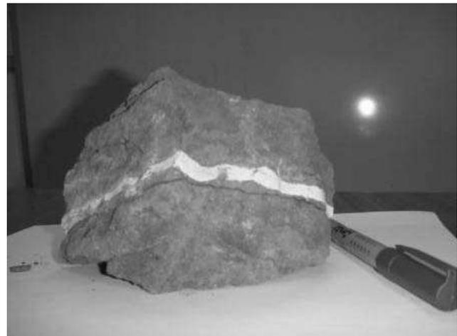
Figure 5. Colmatage d'une fissure dans un échantillon de Périte
