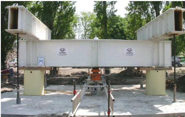
Figure 5. Vue du dispositif d'essai en cours de chargement du micropieu
