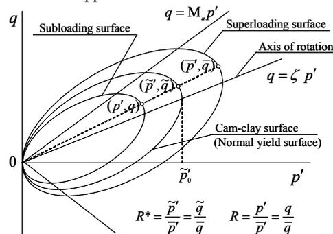
Figure 1. Three loading surfaces (*Nakano et al.*)
