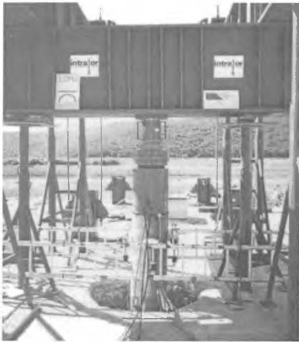
Figure 1. Vue générale de l'essai de chargement du pieu P3.
