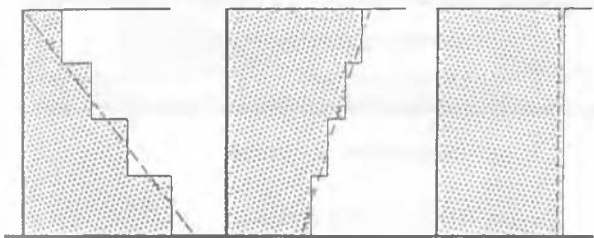
a) Triangulaire b) Trapézoïdal c) Rectangulaire Figure 3.1 Massif structural TER-VOILE
