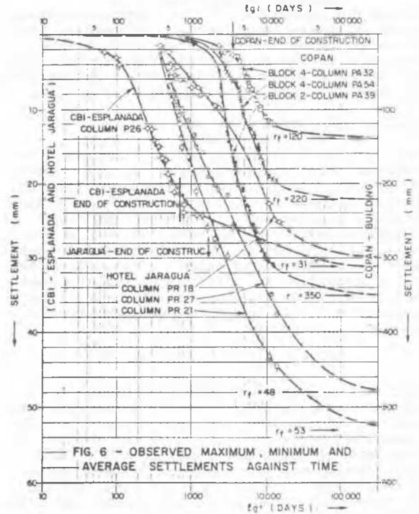
FIG. 6 - OBSERVED MAXIMUM, MINIMUM AND AVERAGE SETTLEMENTS AGAINST TIME
