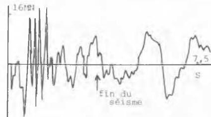
Figure 8 - Reaction verticale sur un groupe de pieux.
