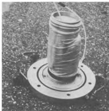
Fig. 1 - Epreuve de Texsol rompue à l'essai triaxial
