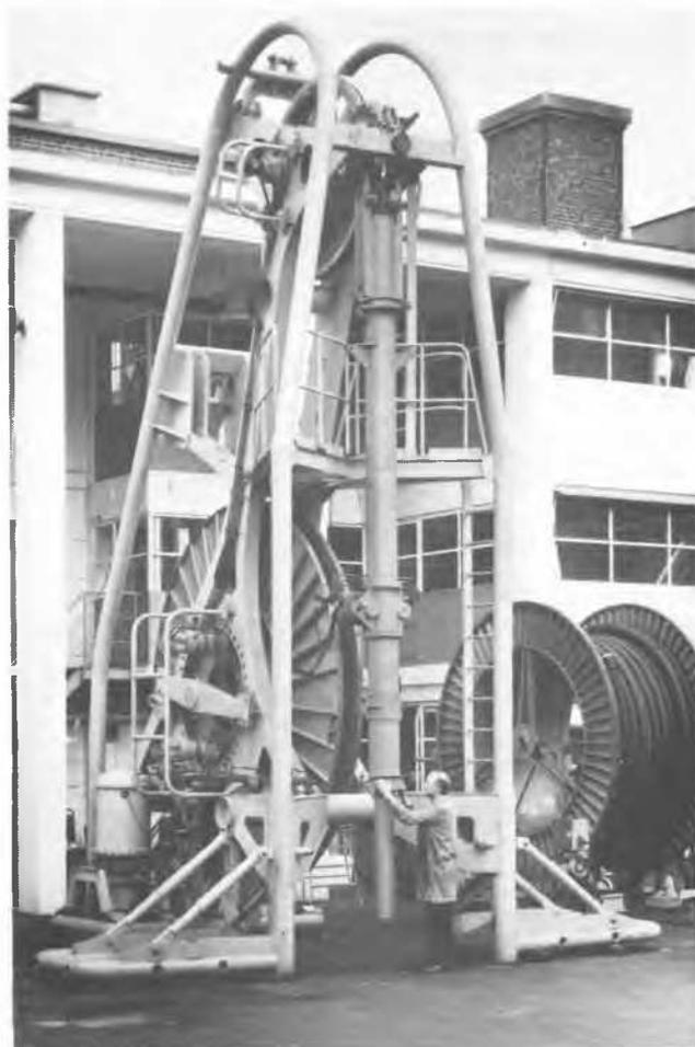
Fig. 1 - Appareil d'autoforage pour la reconnaissance des sols en mer.
