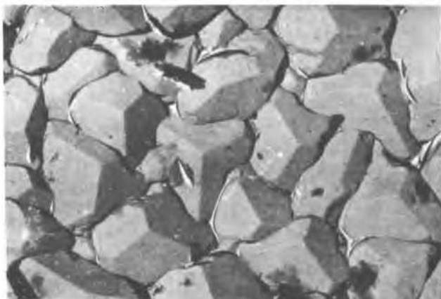
Fig. 2 - Reproduction d'une surface de rupture de la craie par photographie au microscope électronique d'une réplique au carbone. Les rhomboédres sont bien visibles, leur diamètre est de l'ordre du micron (Photo du laboratoire de Physique Chimie Métallurgie d'E.D.F.).
