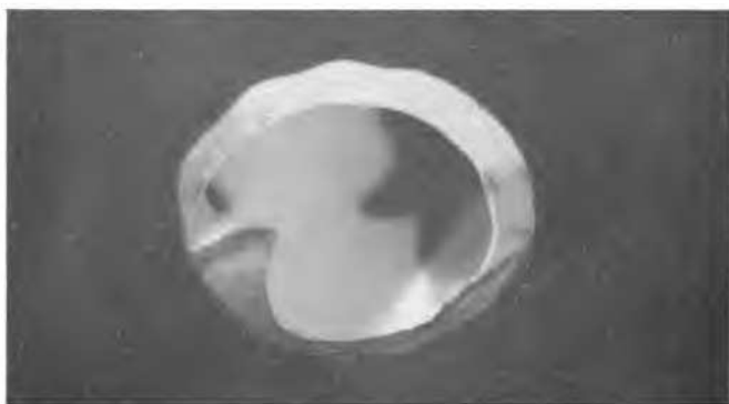
FIG. 3. Rupture par flambage d'ordre n = 6 . Remarquer les 4 ondulations de la partie supérieure de la figure qui ont persisté après l'apparition de la grande cloque inférieure droite.
