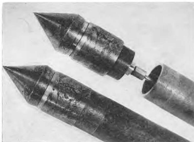
Fig. 3 Pointe du pénétromètre statique de 110 mm de diamètre.
