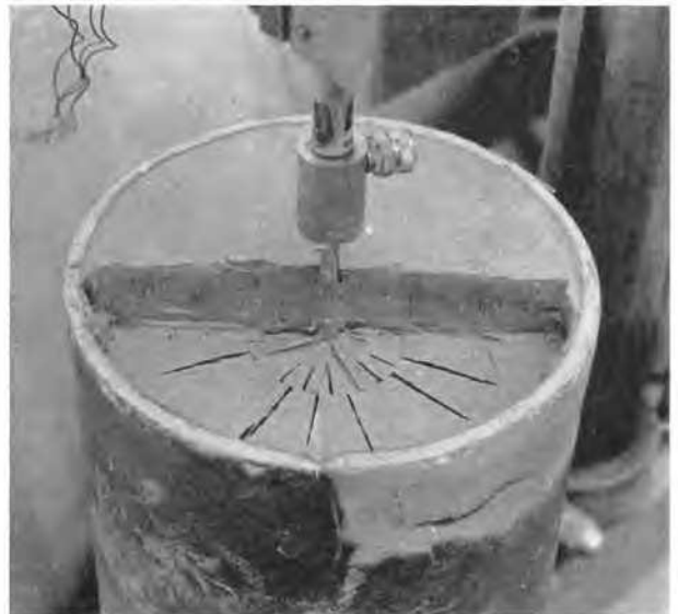
Fig. 10 Surface of rupture at laboratory vane test. Front part of the soil sample cut out to the level of the upper part of the vane. (Radial lines artificially made.) Surface de rupture pendant un essai de moulinet de laboratoire. Partie antérieure de l'échantillon de sol découpée au niveau de la partie supérieure du moulinet. (Les lignes radiales sont artificielles.)
