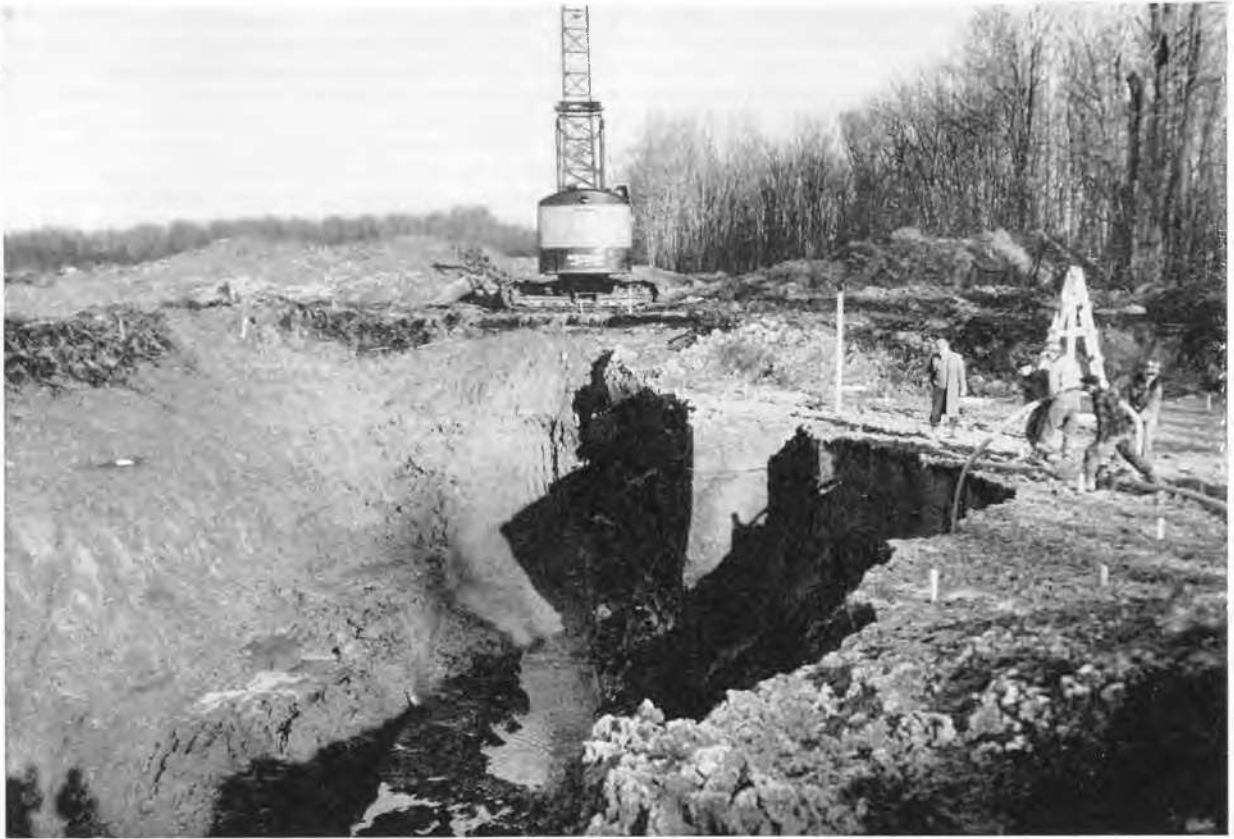
Fig. 3 Location of slides - Massena test trench. Emplacement des glissements - Tranchée d'essai à Masséna.
