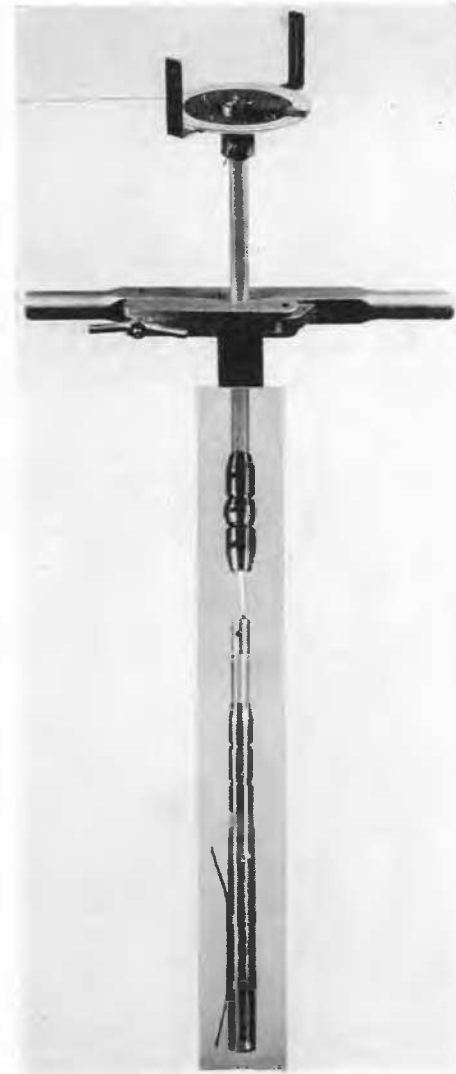
Fig. 5 Strain Gauge Inclinometer. Measuring Set Up. Inclinomètre à gages. Equipement de mesure.
