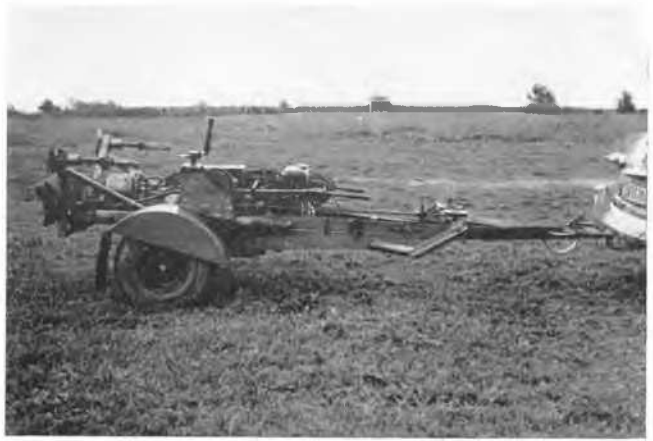
Fig. 2 Asond boring machine ready for transport. La machine de forage Asond en position de transport.
