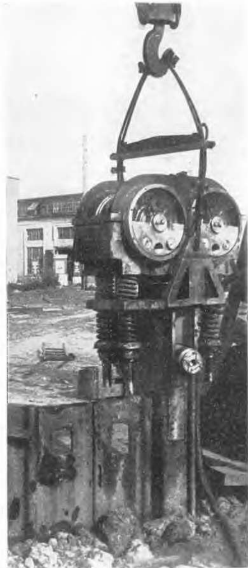
Fig. 9 Vibro-hammer VMC-3A (designed by S. A. Tsaplin). Vibromarteau VMU-3A (étudié par S. A. Tsaplin).
