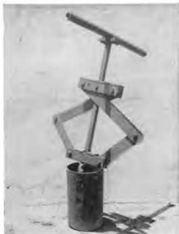
Fig. 3 Portable under-reamer. Dispositif portatif pour réduire le bulbe.
