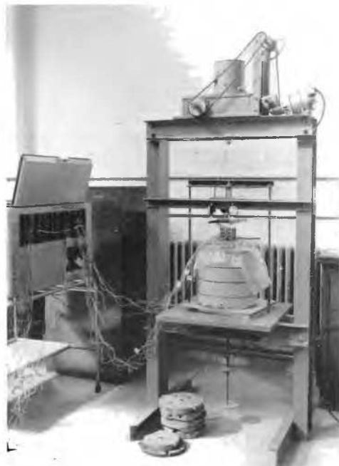
Fig. 3 The testing rig showing arrangements for dead load tests. Le bâti de chargement montrant la disposition des essais de charge.
