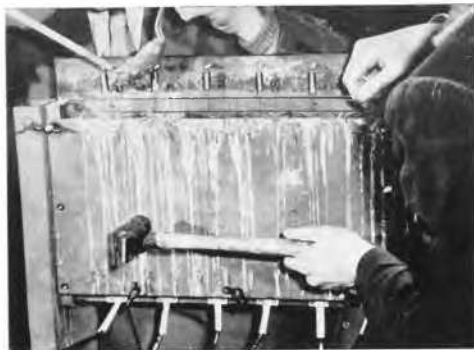
Fig. 4 Grouting of measuring tiles. Remplissage des moules.
