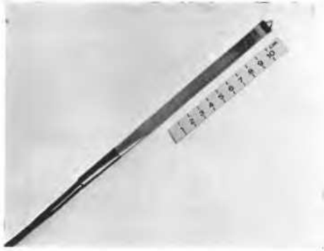
Fig. 1 Internal concrete measuring element. Élément de mesure intérieur.
