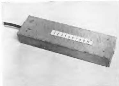
Fig. 2 Concrete measuring tile with embedded measuring element. Dalle de mesure en béton avec élément de mesure encastré.
