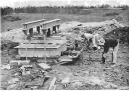
Fig. 5 Direct shear box test in progress. Exécution d'un essai dans la boîte de cisaillement direct.
