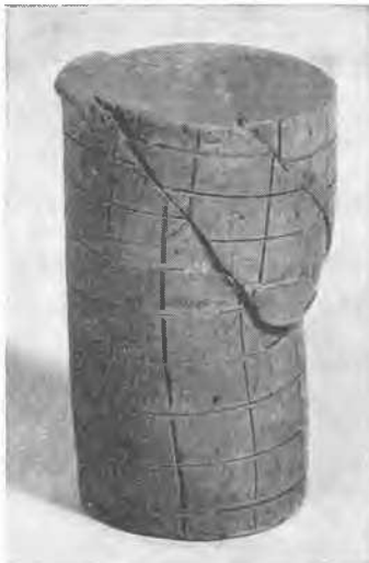
Fig. 2 Plans de rupture d'une éprouvette d'argile plastique Rupture Planes of a Plastic Clay Test Sample
