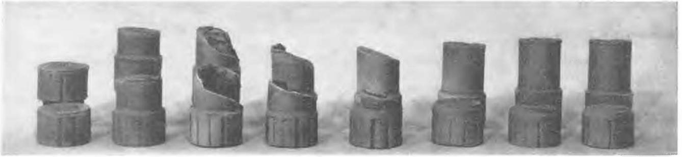
Fig. 14 Orientation des surfaces de rupture en fonction de la charge axiale Orientation of Failure Planes vs. Axial Loading
