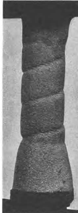
Fig. 10 Essai de torsion avec surface de rupture Torsion Test with Failure Surface
