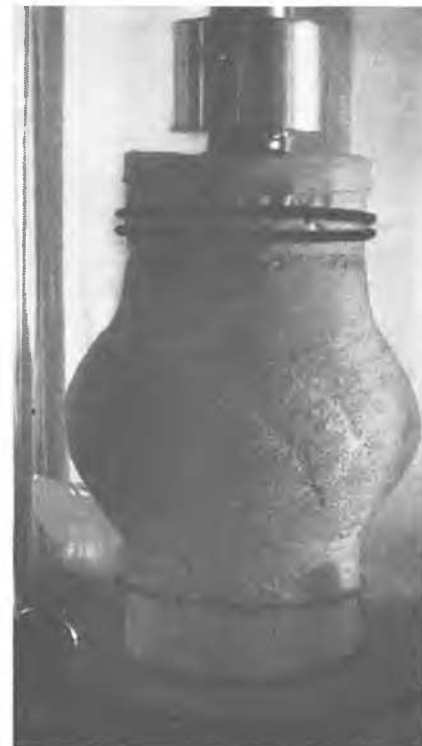
Fig. 8 Sample with Multiple Failure Planes Echantillon présentant plusieurs surfaces de rupture
