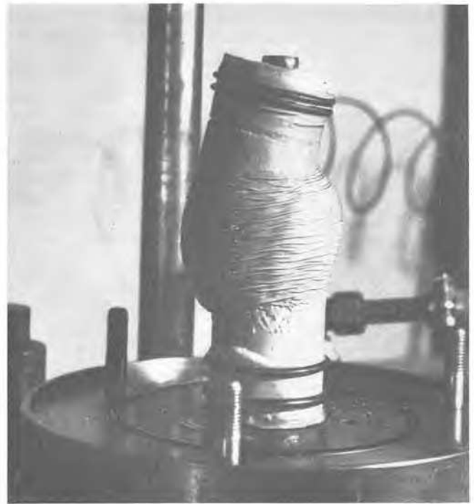
Fig. 7 Sample with a Single Failure Plane Echantillon présentant une surface unique de rupture
