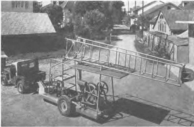
Fig. 1 Press-Ram-Penetrometer during Transportation Sonde de pénétration statique et dynamique. Transport
