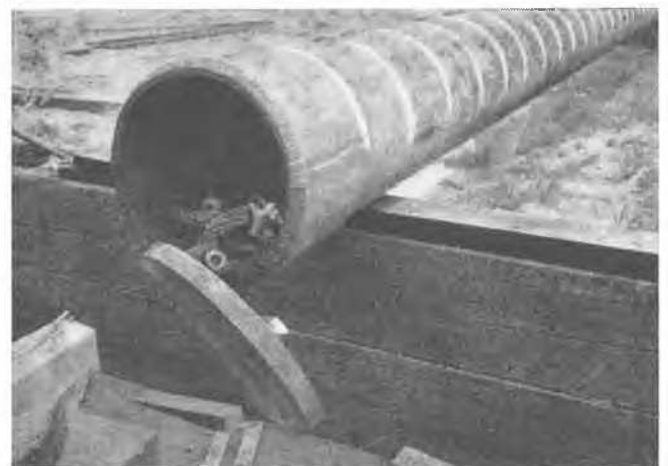
Fig. 7 Hollow Steel Mandrel with Hinged Plate at Bottom Mandrin creux d'acier avec plaque à gonds au fond
