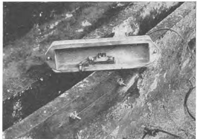
Fig. 5 Gauge Fitted to Segment Réglage du dynamomètre au segment
