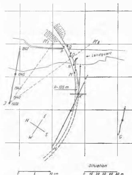
Fig. 2 Situation of Benchmarks ( $Pf_1$  and  $Pf_{11}$ ) and Horizontal Projection of Measured Displacements 1938–1952 Situation des repères ( $Pf_1$  et  $Pf_{11}$ ) et projection horizontale des déplacements mesurés de 1938 à 1952
