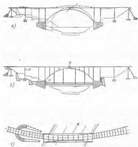
Fig. 1 Deformations of the Bridge, December 1938, Scheme (a) Strengthening Work in Longitudinal Section (b) and Plane (c) Déformation du pont, décembre 1938, schéma (a), schéma des travaux confortatifs, coupe (b) et plan (c)
