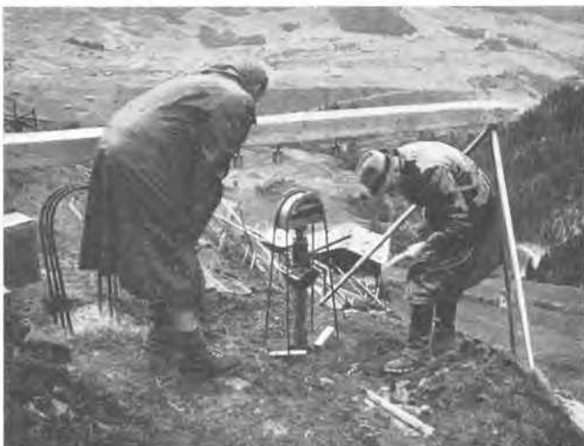
Fig. 14 Presse de 12 t pour essais sur le terrain 12 t Jack for Field Tests
