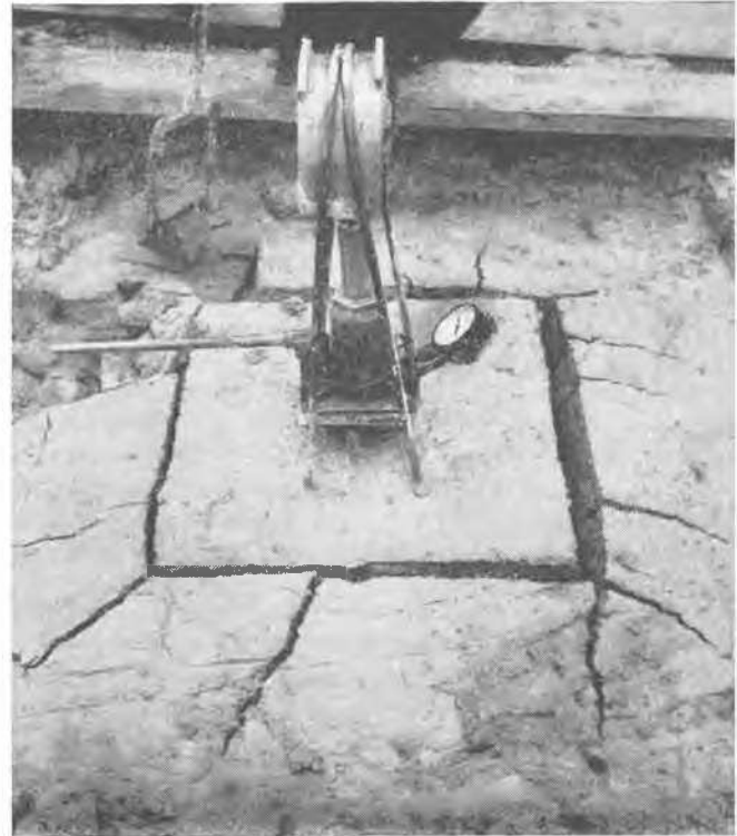
Fig. 17 Essai dans de l'argile grasse – Bloc de fondation à base évasée S = 1,60 \text{ t/m}^2 Test in Adhesive Clay—Foundation Block with Enlarged Base S = 1.60 \text{ t/m}^2
