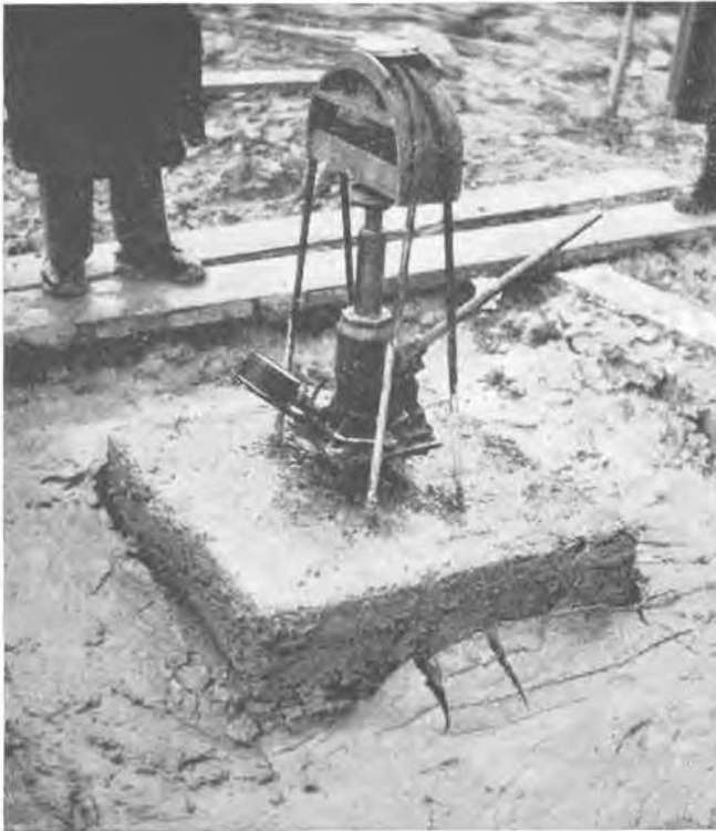
Fig. 16 Essai dans de l'argile grasse – Bloc de fondation à parois verticales S = 1,20 \text{ t/m}^2 Test in Adhesive Clay—Foundation Block with Vertical Walls S = 1.20 \text{ t/m}^2
