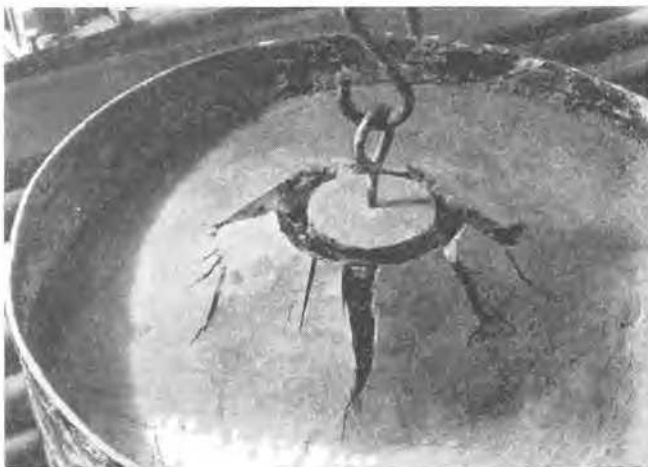
Fig. 6 Etat juste avant la rupture complète State Just Before Complete Rupture
