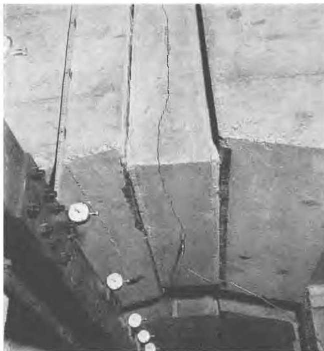
Fig. 17 Photographie des vérins capsulaires avec le dispositif de mesure des déformations. Le vérin a été gonflé. Son enrobage a éclaté Measurement of the Elastic Modulus of the Rock. Photograph of the Loading Cells with the Arrangement for Measuring Deformations. The Cell has been Pumped Up, and its Cover has Burst
