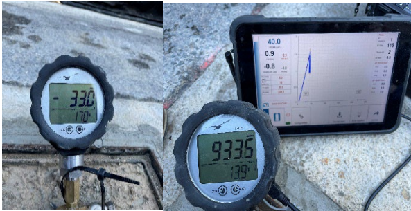
Figure 5. Manomètre numérique enregistreur en tête de forage et processus de remplissage de la sonde Géocell.
