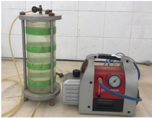
Figure 4. Désaération de l'eau à l'aide de la pompe
