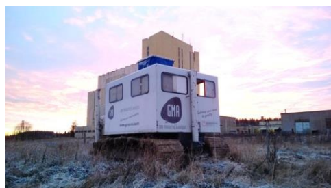
Figure 7. 12 ton CPT rig in Perniö (Salo).
