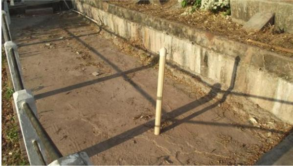
**Figure 13 Inclinometer**
