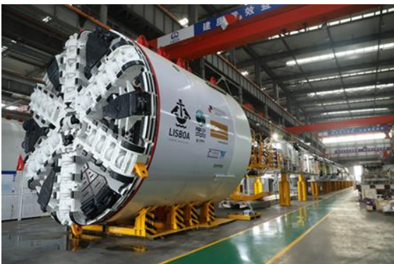
Figure 7. Réception en atelier du tunnelier « Oli ».
