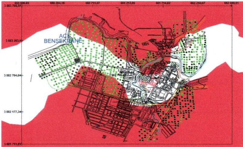
Figure 11. Superposition des enjeux avec la carte dû au retrait-gonflement (ACL Bensekrane).
