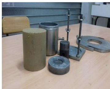
Figure 3. Échantillon de sol ( $S_0$ ) compacté à l'optimum de Proctor
