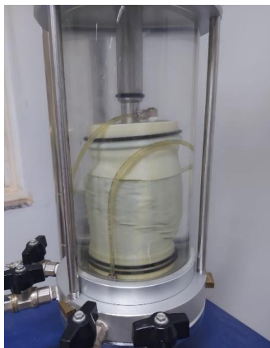
Figura 7. Corpo de prova após término do ensaio triaxial drenado.
