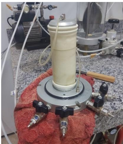
Figura 2. Corpo de prova remodelado para o ensaio triaxial.
